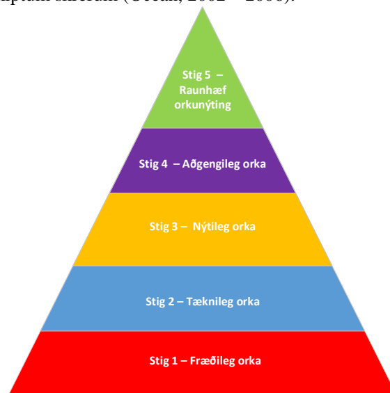
Mynd 3.2.1-3 Fimm stig áætlunargerðar vegna nýtingar sjávarfalla og strauma við stendur Írlands.
